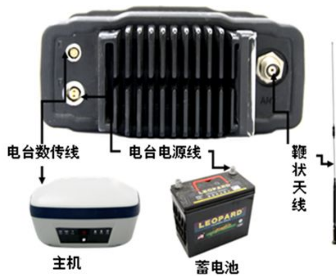
图 2-4 电台连接图
