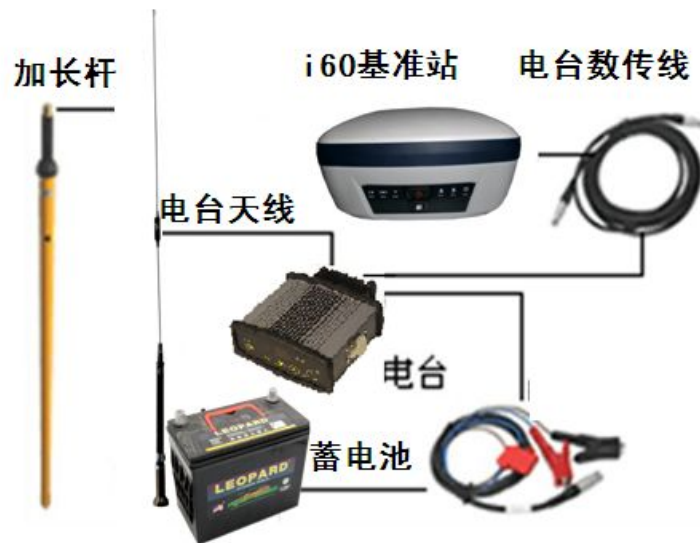
图 2-2 电台模式整体连接图
