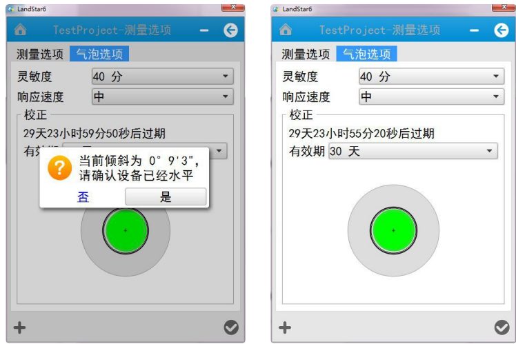
图 5-16 电子气泡校准
