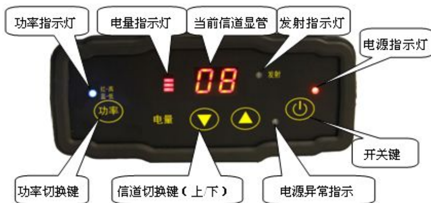
图 2-7 电台面板及各功能示意图
